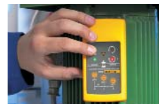
Determine el sentido de giro de motores en funcionamiento sin contacto con tan sólo colocar el instrumento sobre la carcasa del motor.
